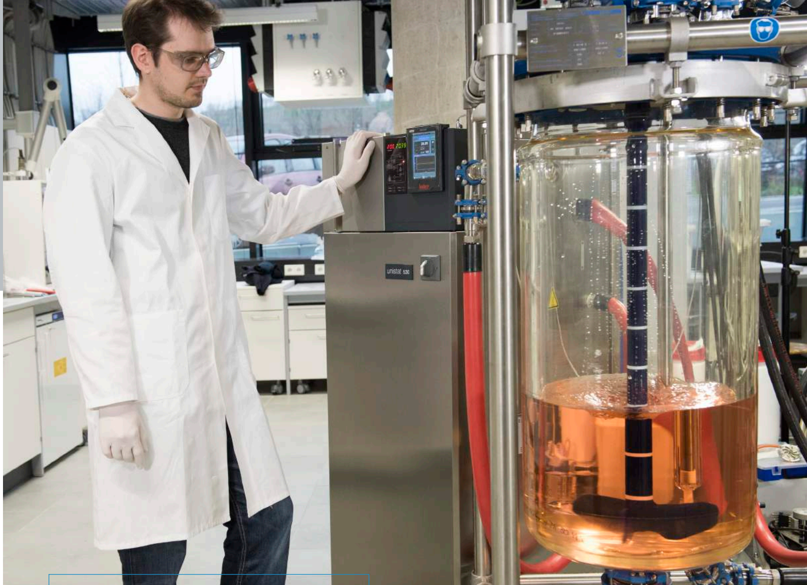
DER RÜHRREAKTOR... ... für Partikelsynthesen im Maßstab 100 Liter.
