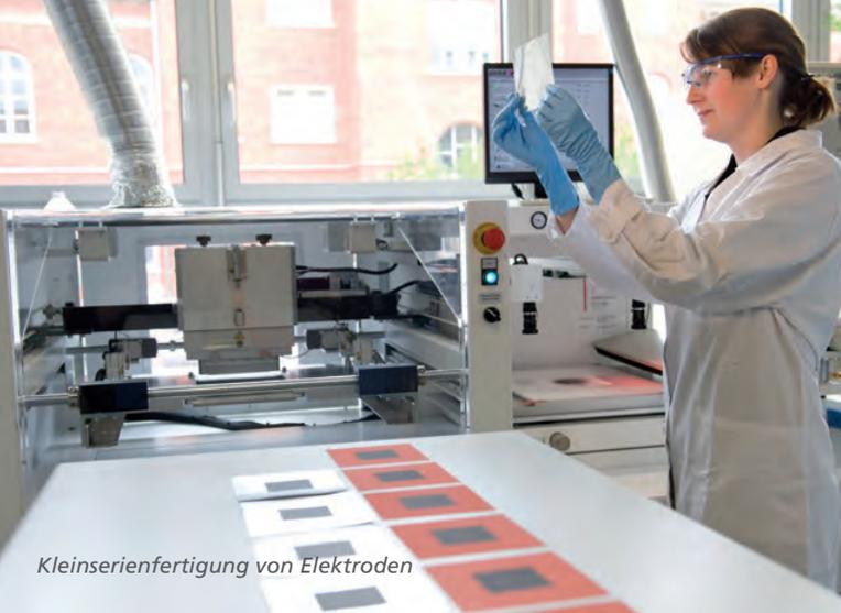
Kleinserienfertigung von Elektroden
