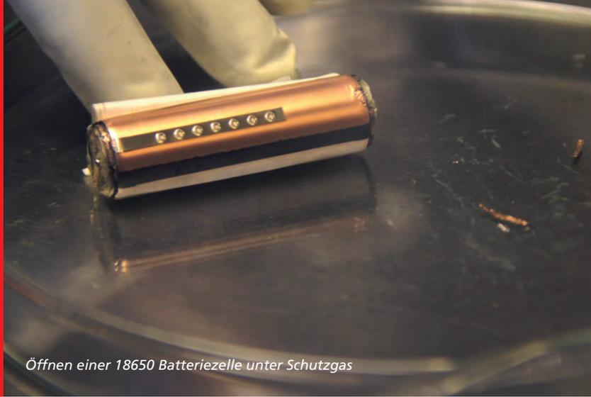
Öffnen einer 18650 Batteriezelle unter Schutzgas
