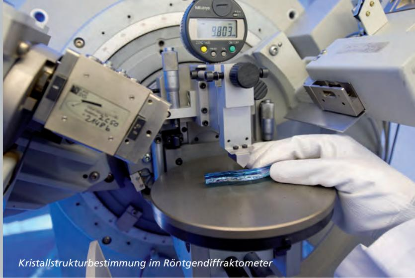
Kristallstrukturbestimmung im Röntgendiffraktometer
