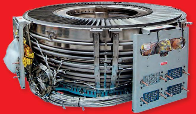
Niederdruckturbinen (Quelle: MTU Aero Engines)
