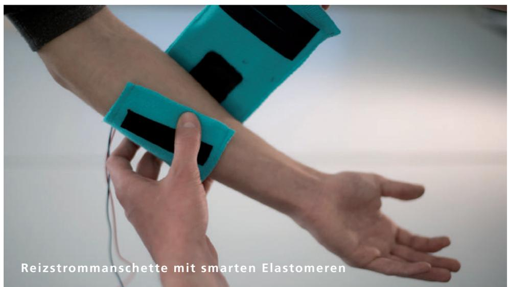
Reizstrommanschette mit smarten Elastomeren
