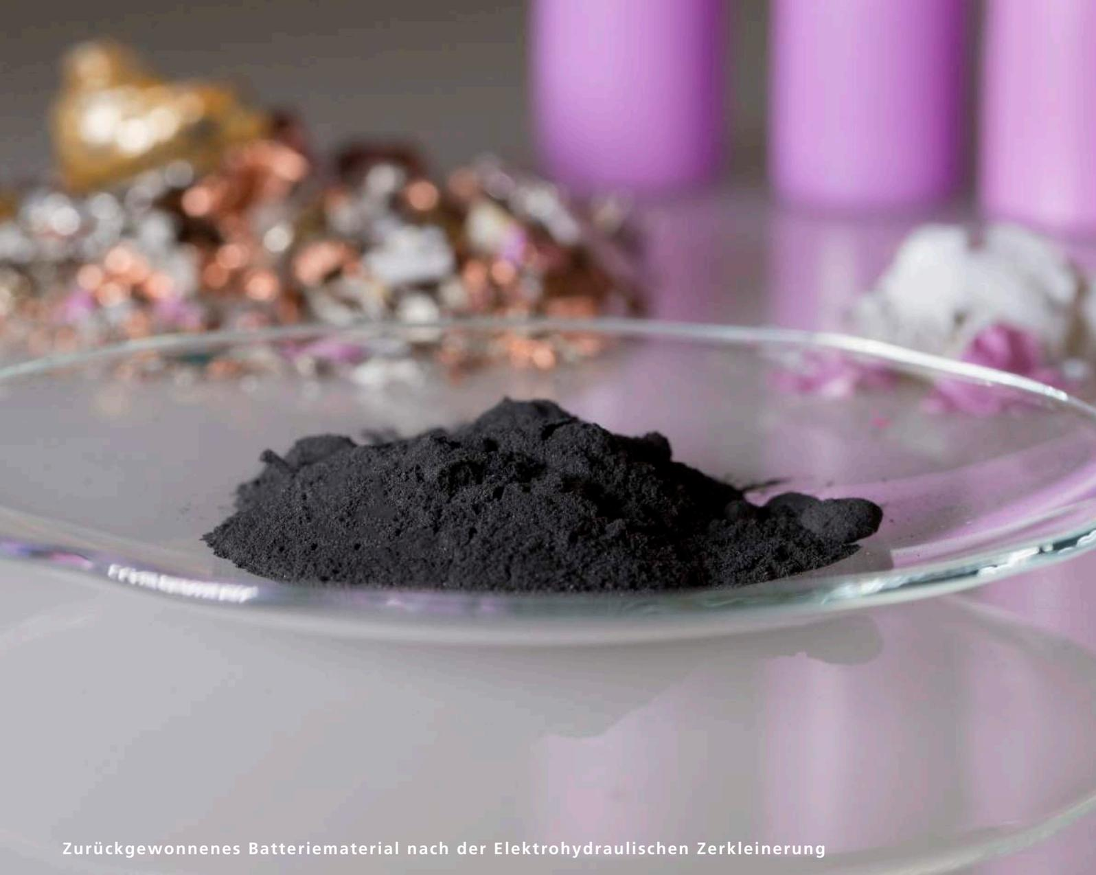
Zurückgewonnenes Batteriematerial nach der Elektrohydraulischen Zerkleinerung
