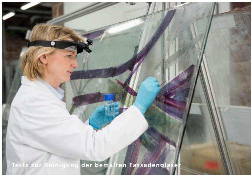
Tests zur Reinigung der bemalten Fassadengläser
