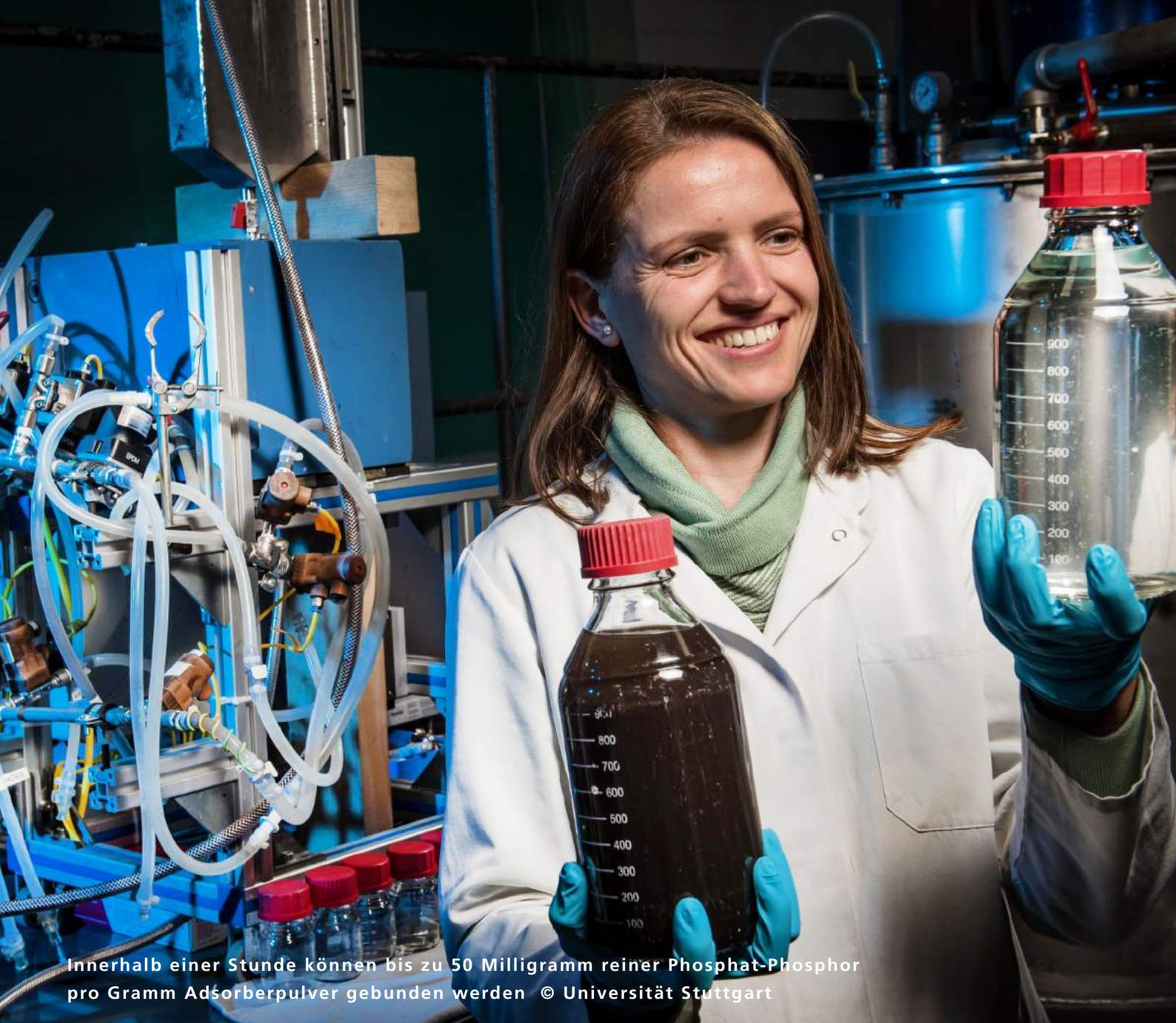
Innerhalb einer Stunde können bis zu 50 Milligramm reiner Phosphat-Phosphor pro Gramm Adsorberpulver gebunden werden © Universität Stuttgart
