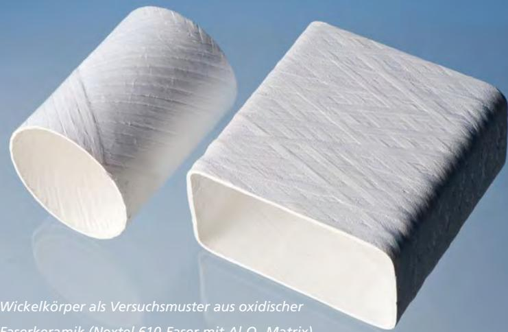
Wickelkörper als Versuchsmuster aus oxidischer Faserkeramik (Nextel 610-Faser mit  $Al_2O_3$ -Matrix)
