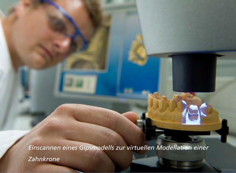
Einscannen eines Gipsmodells zur virtuellen Modellation einer Zahnkrone
