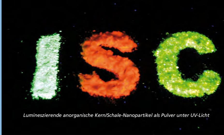
Lumineszierende anorganische Kern/Schale-Nanopartikel als Pulver unter UV-Licht
