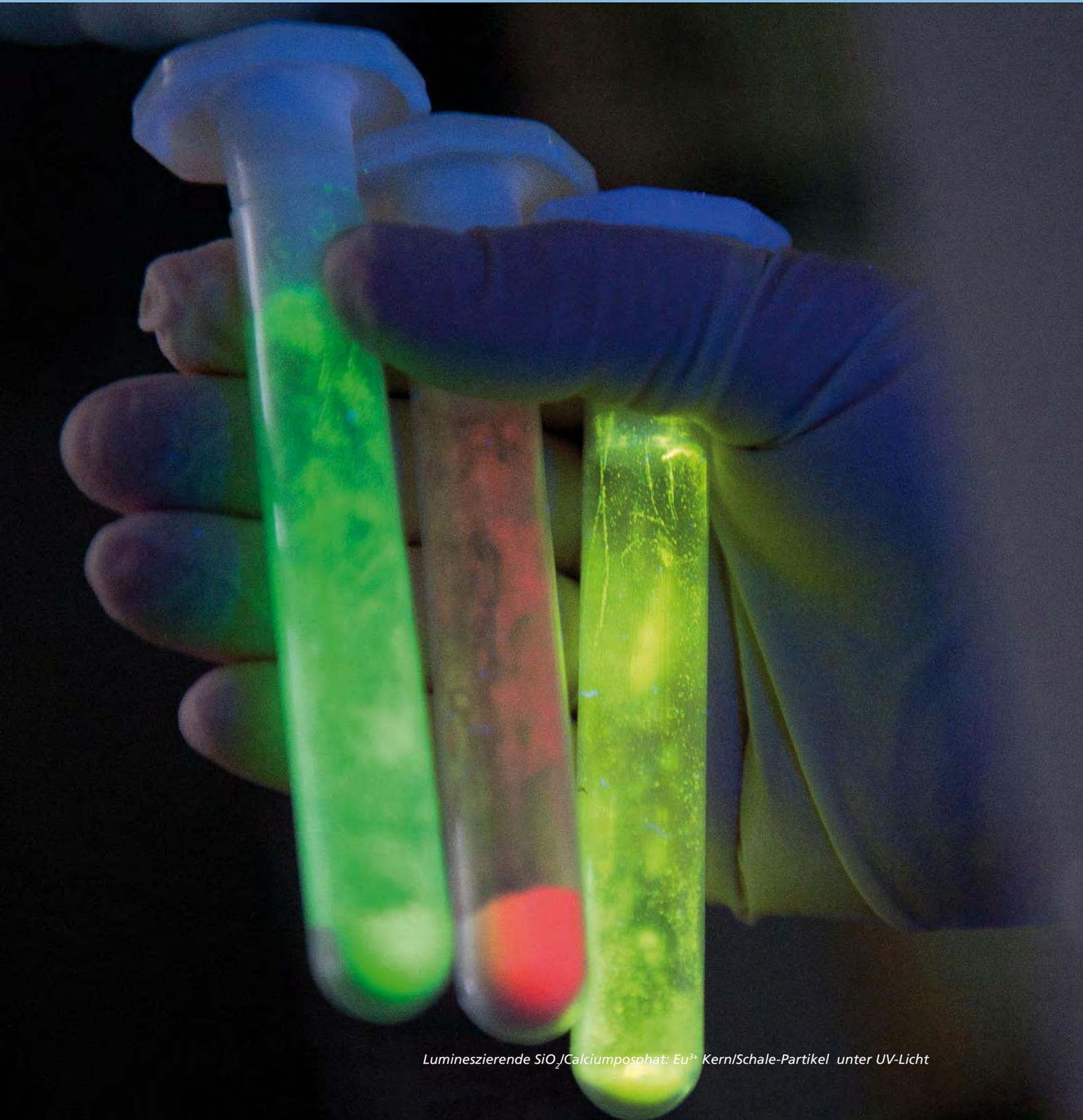
Lumineszierende  $\text{SiO}_2/\text{Calciumphosphat}$ :  $\text{Eu}^{3+}$  Kern/Schale-Partikel unter UV-Licht
