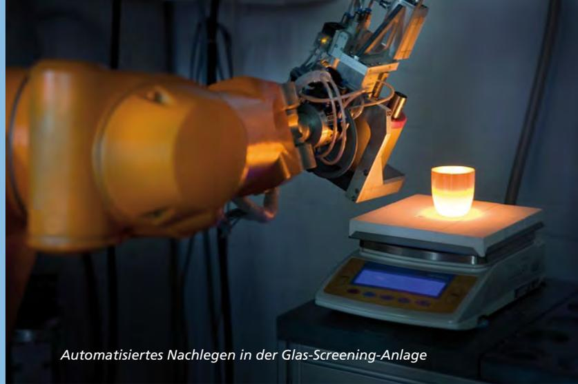
*Automatisiertes Nachlegen in der Glas-Screening-Anlage*
