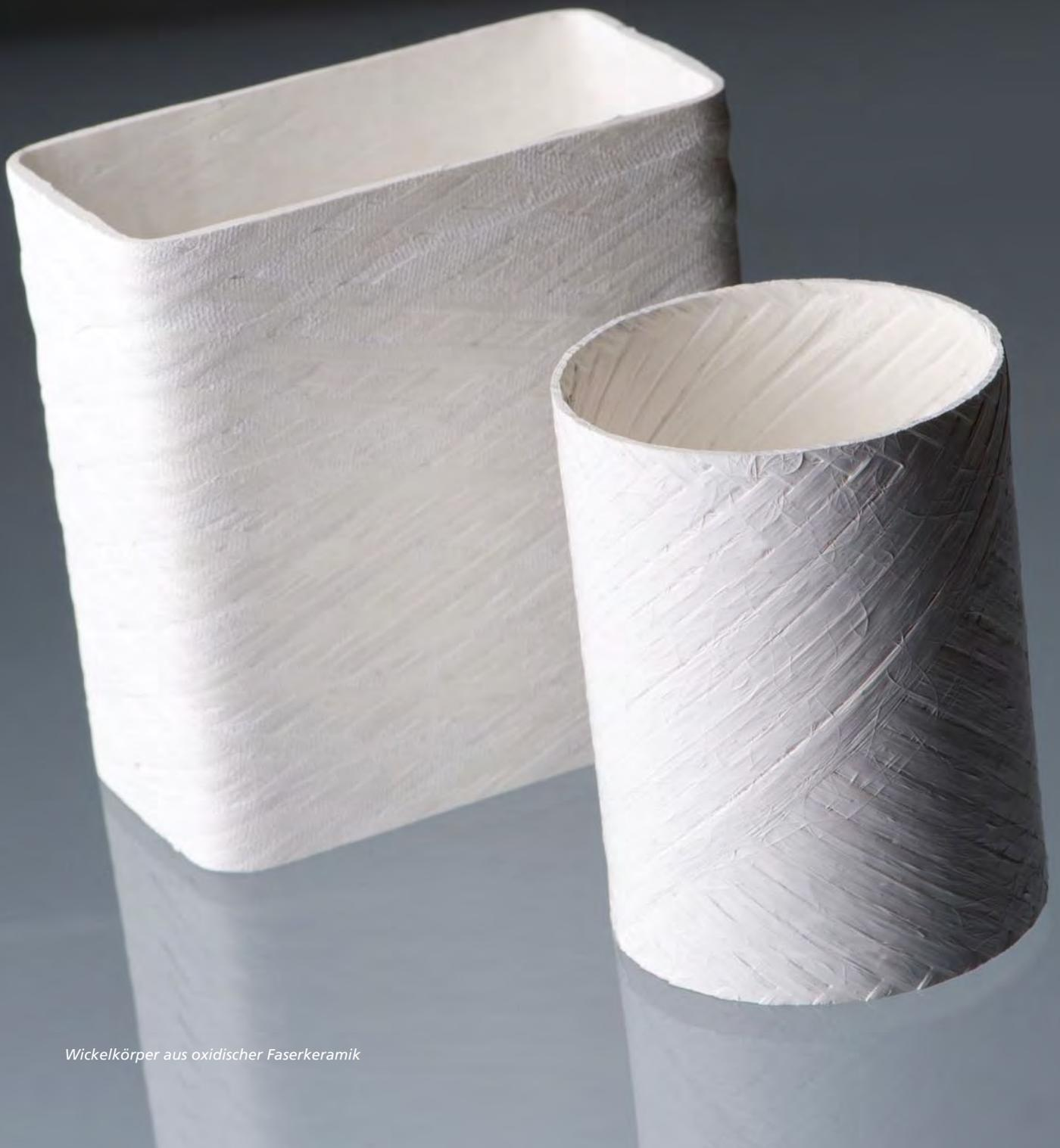
*Wickelkörper aus oxidischer Faserkeramik*
