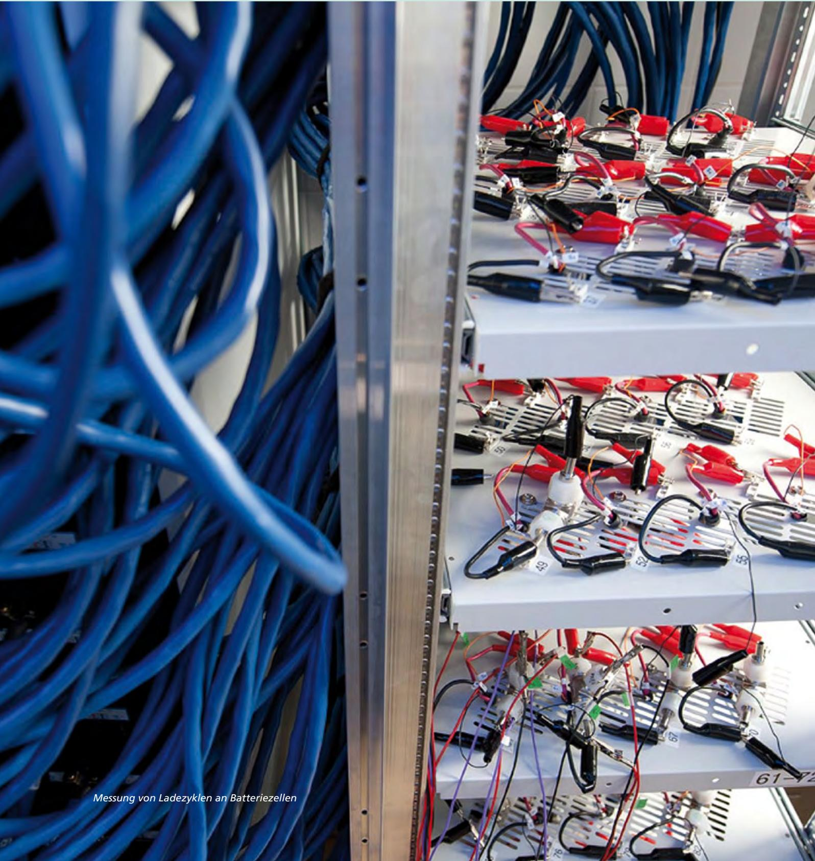
Messung von Ladezyklen an Batteriezellen
