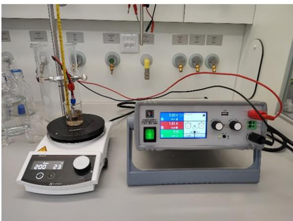
**Abb. 3 Aufbau eines elektrochemischen Oxidationsversuches: Diamantelektroden in schwefelsaurer Arsen(III)-oxid-Lösung**
