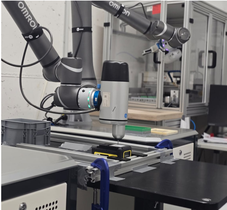
Abb. 2 Automatisierte Demontage eines Batterie-Moduls im Fraunhofer IWKS Robotik-Lab. © Fraunhofer IWKS
