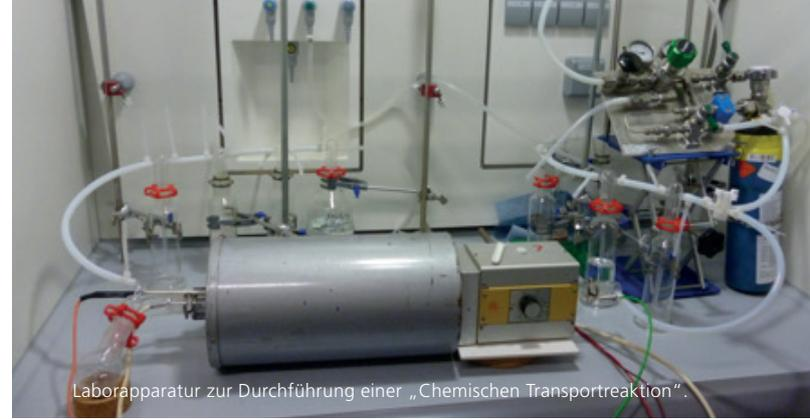
Laborapparatur zur Durchführung einer „Chemischen Transportreaktion“.
