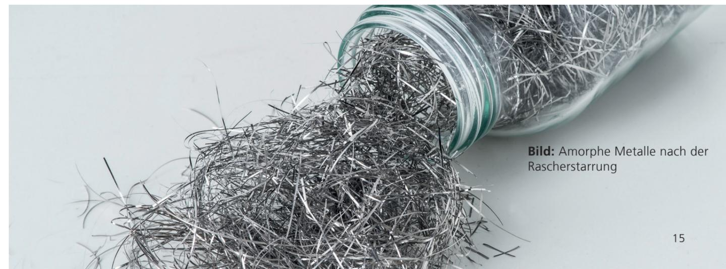
**Bild:** Amorphe Metalle nach der Rascherstarrung
