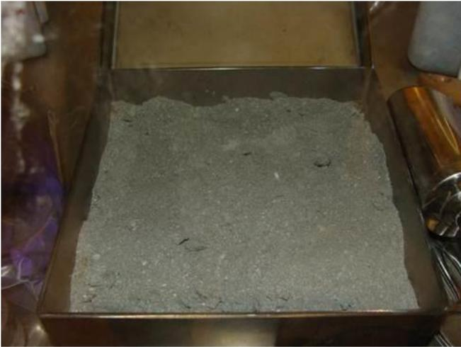
**Abb. 42: Magnetpulver aus Altmagneten (nach Wasserstoffversprödung, Aufnahme von CEA zur Verfügung gestellt).**
