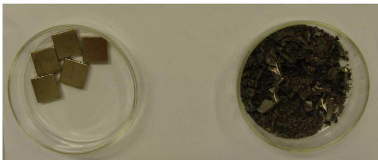
**Abb. 60: Magnete mit einer Ni/Cu-Beschichtung vor (links) und nach dem HD-Prozess (rechts), Bild CEA.**
