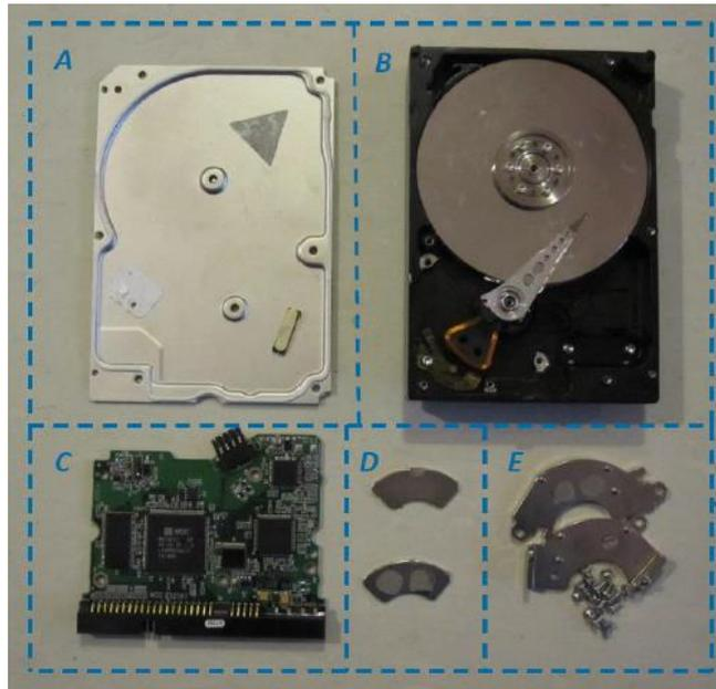
**Abb. 13: Darstellung einer vollzerlegten handelsüblichen Festplatte (A: Deckel aus Stahl; B: Gerüst mit Datenscheibe und Lesekopf; C: Leiterplatte; D: Permanentmagnete; E: Stahlträger mit zugehörigen Schrauben).**
