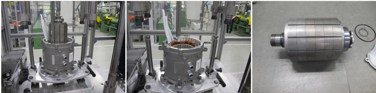
**Abb. 20: Auspressen / Herausziehen des Rotors bei einer SMG180.**
