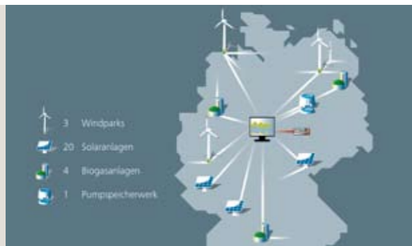
Versorgungskonzept Netz für Strom aus regenerativen Quellen
