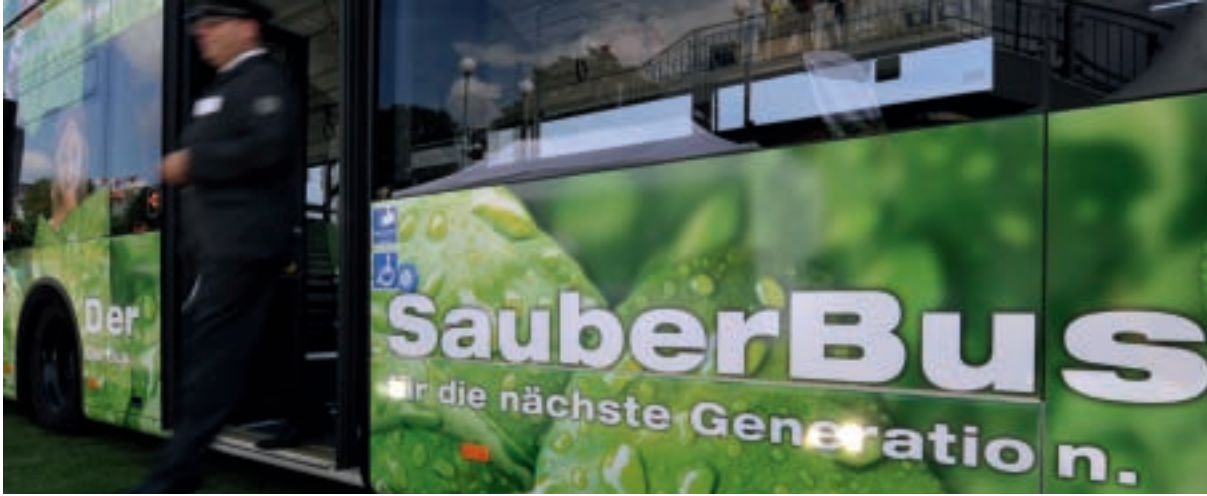
Der Hybridbus führt Treibstoff mit sich, der mittels einer Brennstoffzelle in elektrischen Strom für die Antriebsmotoren umgewandelt wird.
